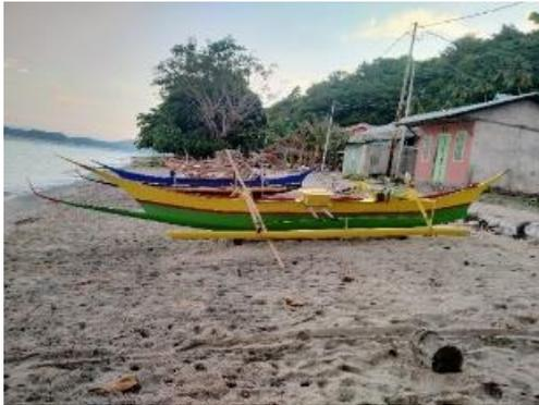
Spesifikasi perahu yang digunakan oleh nelayan penangkap ikan kurisi yaitu ditunjukkan pada Tabel 8 sebagai berikut. Perahu yang digunakan terbuat dari kayu dan dibuat swadaya oleh nelayan dengan bantuan nelayan lainnya. Panjang keseluruhan perahu yaitu 7,30 m. Perahu digerakkan dengan menggunakan mesin.
